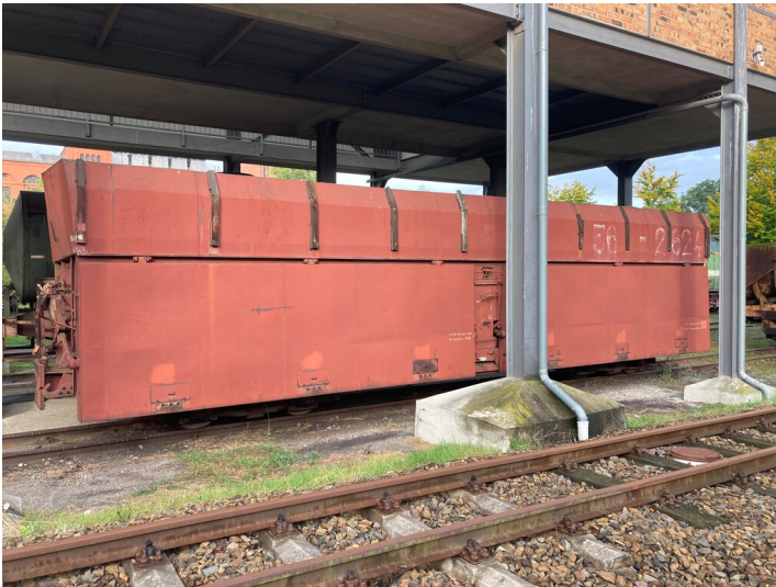
Sattelboden-Selbstentlader 56-2624 für das Netz der Grubenspur im Lausitzer und Mitteldeutschen Revier Fotograf/Urheber: Tom Pfefferkorn
