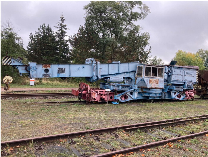
Eisenbahndrehkran EDK 58/ 1957. Es wurden von KIROW Leipzig und Lauchhammerwerk nur drei Exemplare für die 900 mm-Spur hergestellt. Fotograf/Urheber: Tom Pfefferkorn
