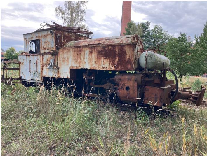
In Berzdorf zu Ellok umgebaute Dampflokomotive, ursprünglich 1927 von Borsig, Berlin gefertigt Fotograf/Urheber: Tom Pfefferkorn
