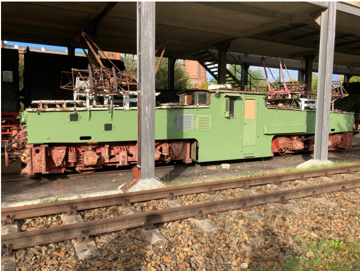
Ellok EL3 4-96-75-A2, sogenannte 75-Tonnen Lok, bei LEW Hennigsdorf 1954 gebaut Fotograf/Urheber: Tom Pfefferkorn
