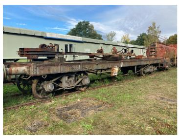
Brikettfabrik Werminghoff/ Knappenrode, Flachwagen 7, genietete Konstruktion mit vier durchlaufenden Längsträgern Fotograf/Urheber: Tom Pfefferkorn
