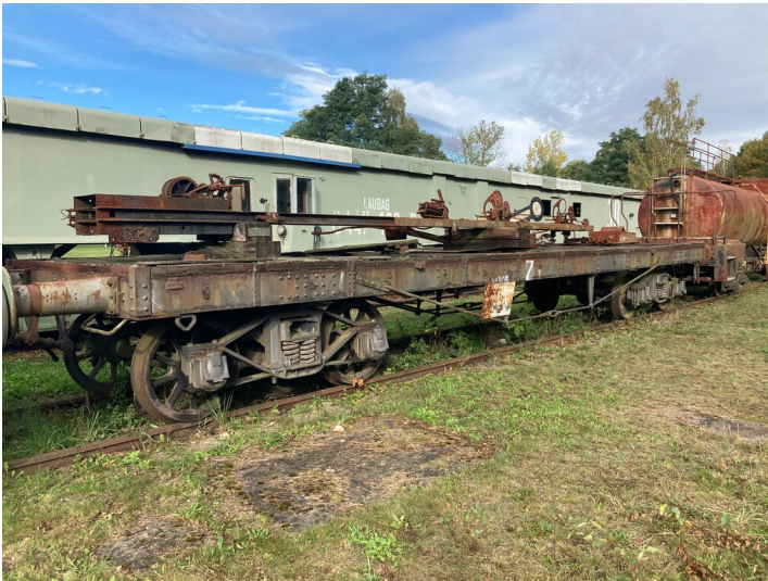
Brikettfabrik Werminghoff/ Knappenrode, Flachwagen 7, genietete Konstruktion mit vier durchlaufenden Längsträgern Fotograf/Urheber: Tom Pfefferkorn
