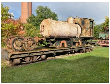
Dampfspeicherlokomotive HANOMAG (Torso), auf Flachwagen, zuletzt verwendet als Löschwasserreservoir Fotograf/Urheber: Tom Pfefferkorn
