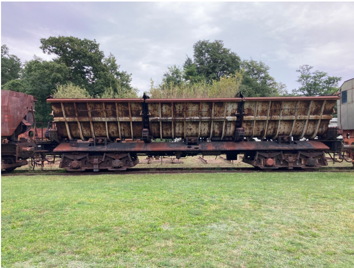
Muldenkippwagen für Nassaschetransport, Einsatz in Großkraftwerken und der chemischen Industrie als Werkswagen Fotograf/Urheber: Martin Neubacher
