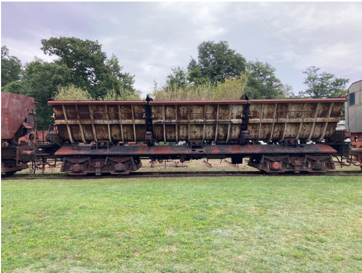
Muldenkippwagen für Nassaschettransport, Einsatz in Großkraftwerken und der chemischen Industrie als Werkswagen Fotograf/Urheber: Matin Neubacher
