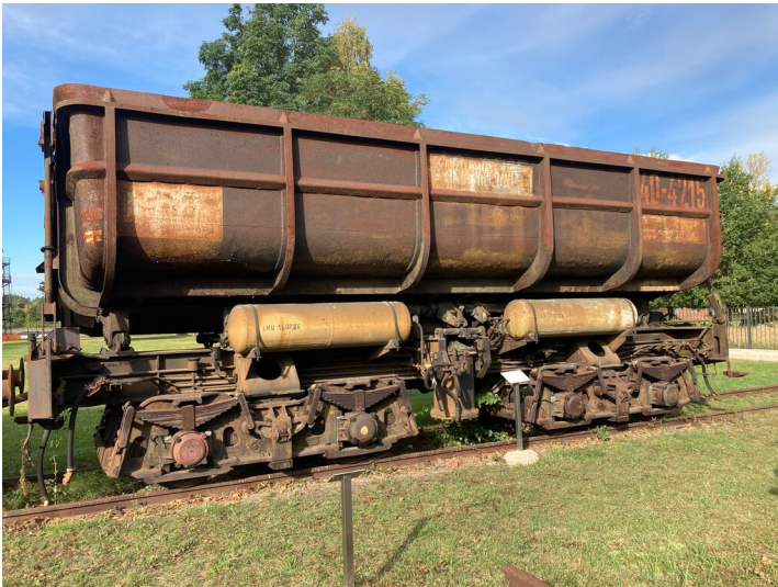
Einseiten-Kastenkipper 40 m 3 , Betr.-Nr. 40-4215, geschlossene Seite Fotograf/Urheber: Tom Pfefferkorn
