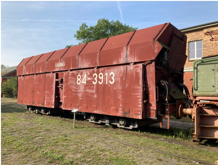
Sattelboden-Selbstentlader 84-3913 Teil der Objektgruppe Regelspurfahrzeuge Fotograf/Urheber: Kathrin Krüner
