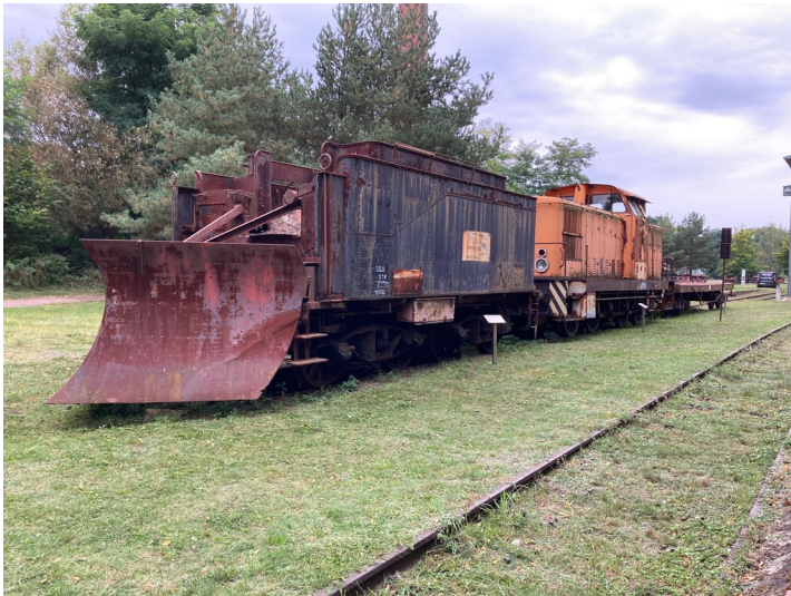
Tenderschneepflug aus Schlepptender BR 38, Eigen(um)bau KAAB Jänschalde Fotograf/Urheber: Nora Wiedemann
