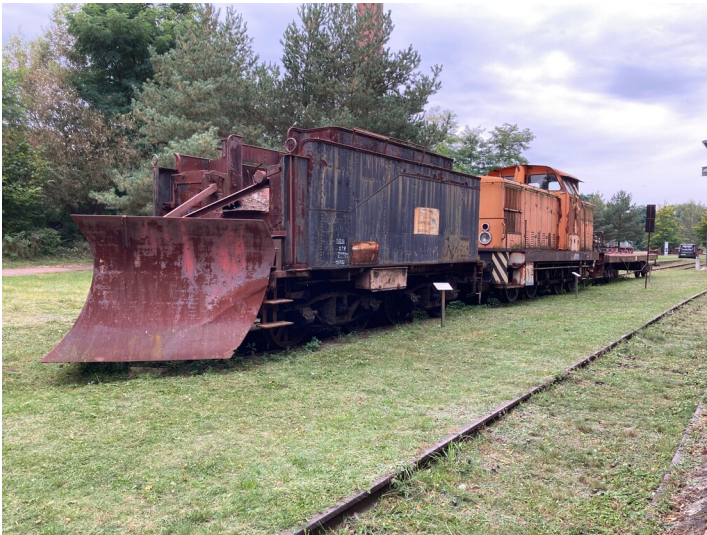
Tenderschneepflug aus Schlepptender BR 38, Eigen(um)bau KAAB Jänschwalde Fotograf/Urheber: Nora Wiedemann
