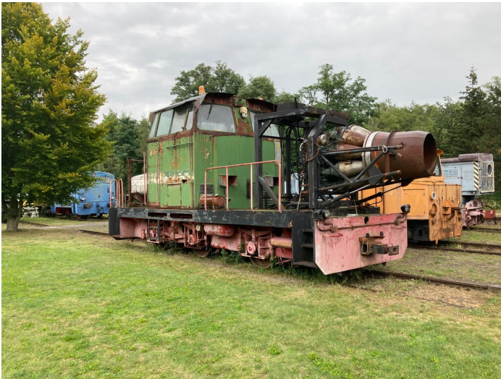
Auftauchergerät (ATG) 4107, auf Basis der tschechischen dieselhydraulischen Rangierlokomotive Typ T 334 Fotograf/Urheber: Matin Neubacher
