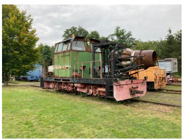
Auftaugerät (ATG) 4107, auf Basis der tschechischen dieselhydraulischen Rangierlokomotive Typ T 334 Fotograf/Urheber: Matin Neubacher
