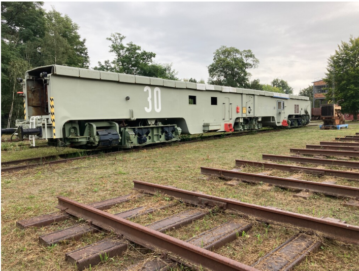
Gleisrückmaschine G447-102-B, G447-102-B LAUBAG, Gerätenummer 30 Fotograf/Urheber: Matin Neubacher
