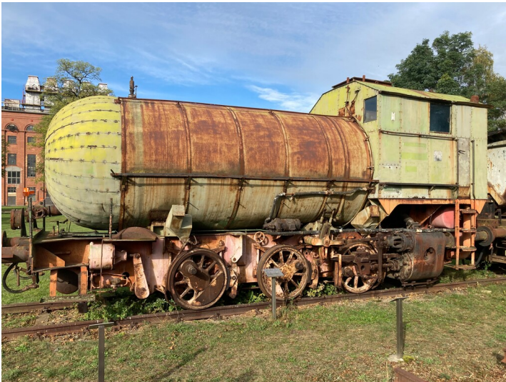
Hochdruck-Dampfspeicherlokomotive Bauart "Gilli", Betr.-Nr. F149-3-13 Fotograf/Urheber: Tom Pfefferkorn
