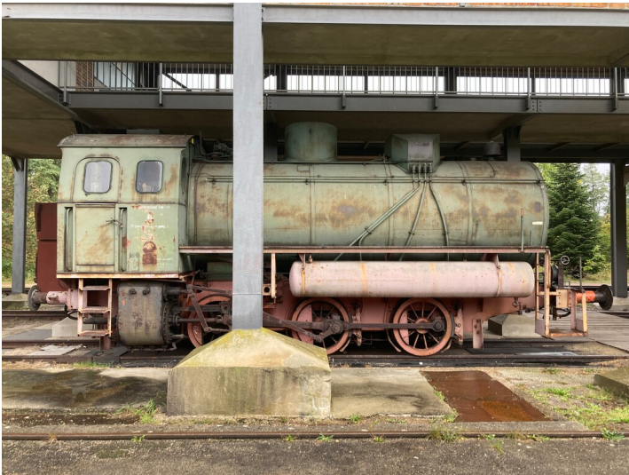
C-gekuppelte Dampfspeicherlokomotive C-fl, ehemals im Energiekombinat Cottbus Lok 4 Fotograf/Urheber: Tom Pfefferkorn
