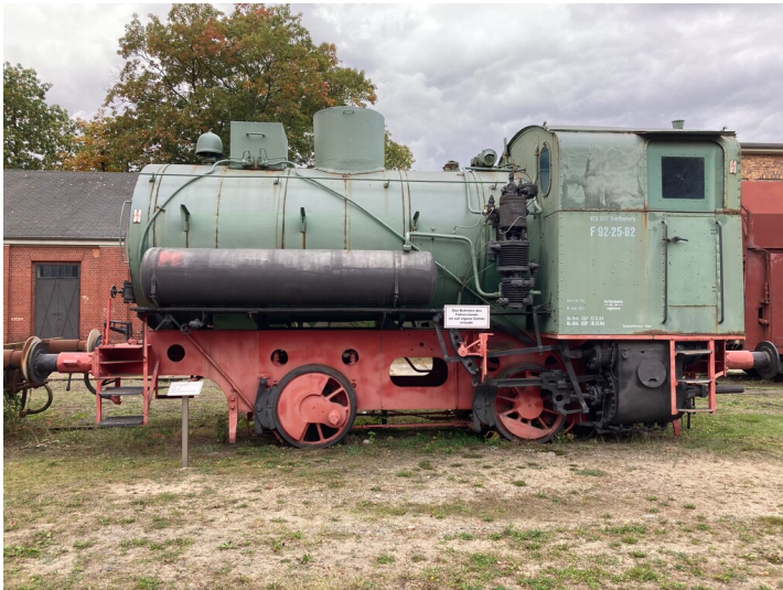
feuerlose Dampfspeicherlokomotive B-fl, Betr.-Nr. F92-25-B2, ursprünglich beheimatet im VEB BKK Senftenberg Fotograf/Urheber: Tom Pfefferkorn
