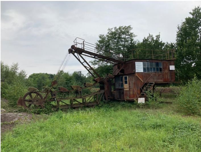
Tagebaugroßgerät auf dem Gelände der Brikettfabrik Knappenrode, Eimerkettenbagger Fs 3150 Fotograf/Urheber: Martin Neubacher
