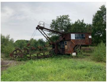
Tagebaugroßgerät auf dem Gelände der Brikettfabrik Knappenrode, Eimerkettenbagger Fs 3150 Fotograf/Urheber: Matin Neubacher
