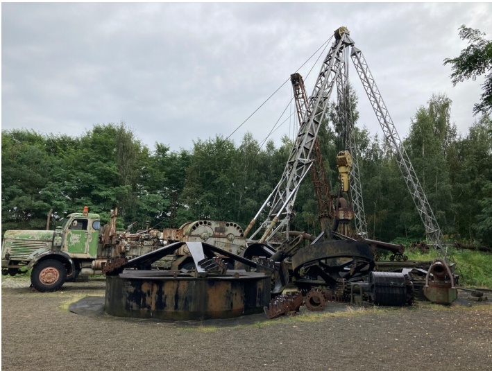
Maschinenpark, Großschachtbohranlage SC 500 Fotograf/Urheber: Martin Neubacher
