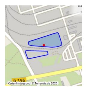
Das Schlammwasserbecken befindet sich südwestlich der Werke I und II. Hier wurden und werden die Kohle- und Asche-Trübenwasser nach der entsprechenden Reinigung eingeleitet. Das restliche Abwasser wird im Schlammwasserbecken gelagert bis entsprechende Grenzwerte erreicht sind zur Einspeisung in den Vorfluter. Das Becken ist im Zusammenhang mit den übrigen Gebäuden des Kraftwerks Boxberg von Interesse.
