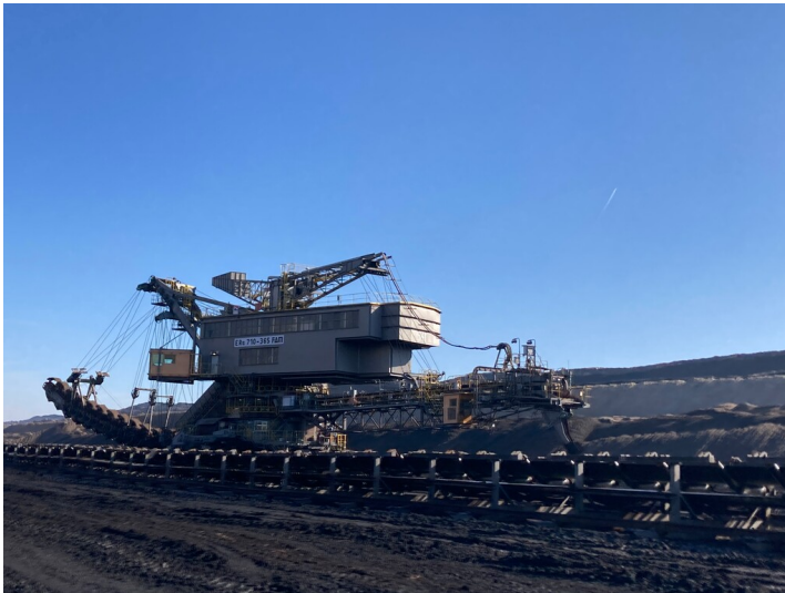
Eimerkettenbagger ERs 365 710 im Tagebau Reichwalde Fotograf/Urheber: Kathrin Kruner
