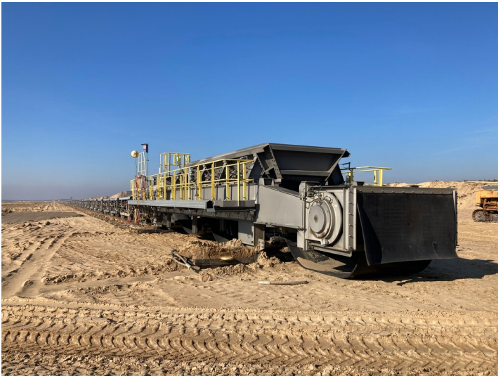
Abraumbandanlage des Tagebaus Reichwalde aus mehreren Einzelbändern und Bandantriebsstationen Fotograf/Urheber: Kathrin Kruner
