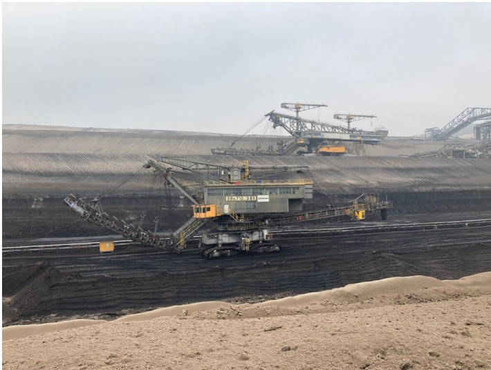
Eimerkettenbagger ERs 361 710 im Tagebau Nochten Fotograf/Urheber: Nora Wiedemann
