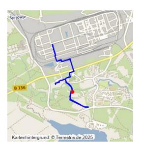
Ein Teil der bei der Stromerzeugung entstehenden Wärme wird aus dem Kraftwerksprozess ausgekoppelt und zur Fernwärmeversorgung am Standort Kraftwerk Boxberg, für die Gemeinde Boxberg und die Stadt Weißwasser genutzt. Die Fernwärmeleitung Boxberg wurde zur Versorgung der Bereitschaftssiedlung Boxberg, der Gärtnerei und des Freibades Boxberg errichtet und wird heute teilweise noch genutzt.
