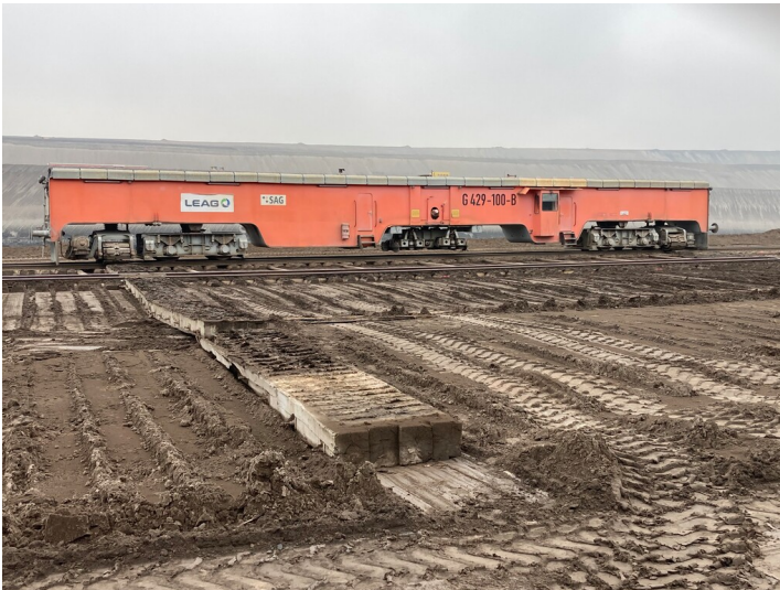
Gleisrückmaschine im Tagebau Nochten Fotograf/Urheber: Tom Pfefferkorn
