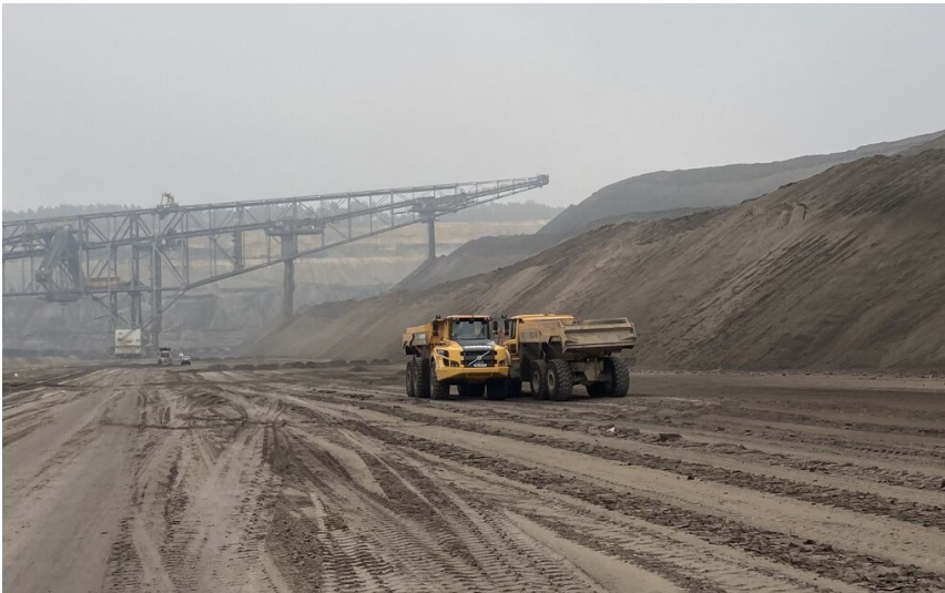
Zwei Geräteträger auf der Förderbrückenebene im Tagebau Nochten Fotograf/Urheber: Nora Wiedemann
