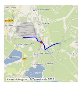
Das gehobene Grubenwasser aus dem Tagebau Nochten wird über die Anlandebecken und eine verrohrte Überleitung zur Grubenwasserbehandlungsanlage nach Schwarze Pumpe geführt und dort für die Weiterverwendung im Kraftwerk oder in der Papierfabrik aufbereitet.
