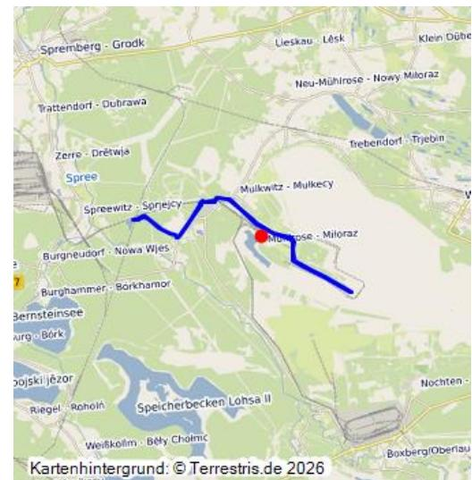
Das zur Entwässerung des Tagebaus Nohken über Filterbrunnenanlagen gehobene Grundwasser (Grubenwasser) wird über einen Überleiter in das Auffangbecken West geführt.
