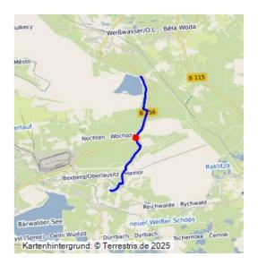
Der Grubenwasser- oder Grundwasserableiter verläuft etwa seit Ende der 1980er Jahre in großen Teilen parallel zur Bundesstraße 156. Er führt das für die Tagebauentwässerung gehobene Grundwasser im Freispiegel zur Grubenwasserbehandlungsanlage Kringelsdorf. Dort wird das Wasser aufbereitet und schließlich dem Modergraben und damit schließlich dem Schwarzen Schöps zugeführt. Damit wird auch der Kühlwasserbedarf des Kraftwerks Boxberg gedeckt.
