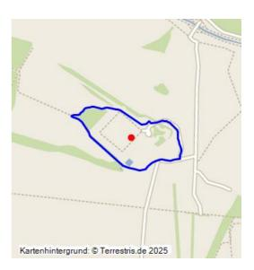
Die Außenkippe mit Aufschlussmassen des Tagebaus Spreetal wurde bereits vor 1987 aufgeschüttet. Sie ist etwa 25 Meter höher als das umgebende Gelände. Das Landschaftsbauwerk in Form eines Pyramidenstumpfes entstand zwischen 1997 und 2005 und sollte als Aussichtspunkt für Touristen dienen. Aufgrund der großen Rutschung im Jahr 2010 gehört dieses Gebiet nach wie vor zum Geotechnischen Sperrbereich und darf nicht betreten werden.
