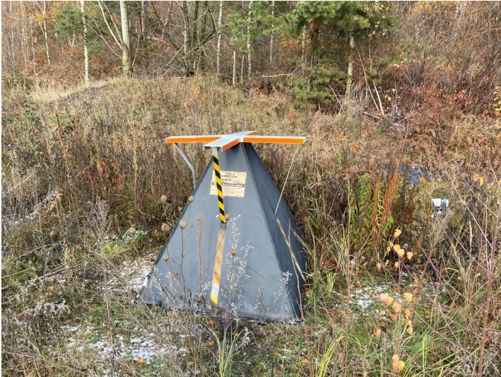
Passpunkt zur Tagebauvermessung Fotograf/Urheber: Nora Wiedemann
