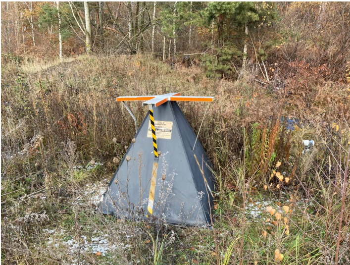
Passpunkt zur Tagebauvermessung Fotograf/Urheber: Nora Wiedemann
