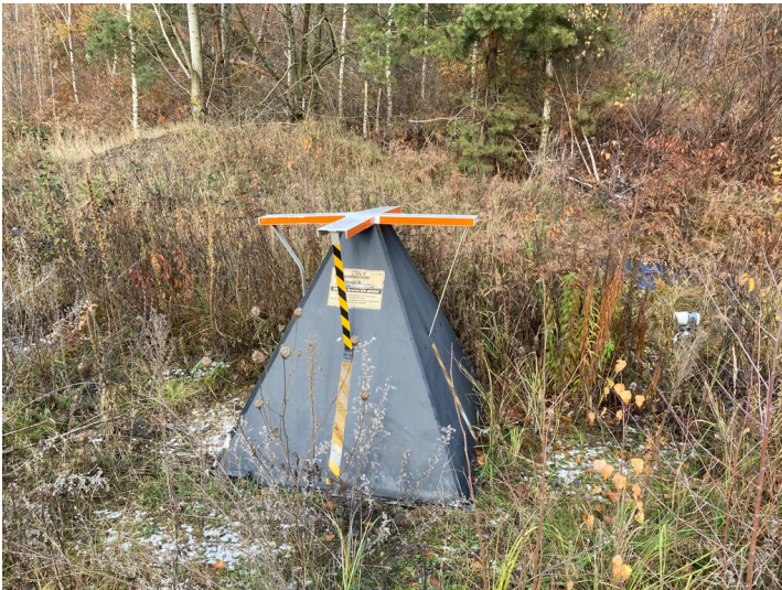
Passpunkt zur Tagebauvermessung Fotograf/Urheber: Nora Wiedemann
