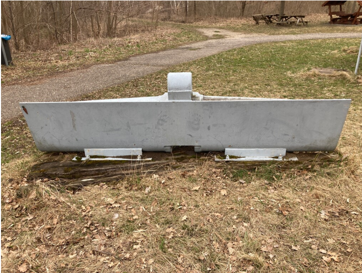
Teil der Objektgruppe Halde Trages (30600141), Raupenbodenplatte des Baggers 1529 Fotograf/Urheber: Cynthia Thomas
