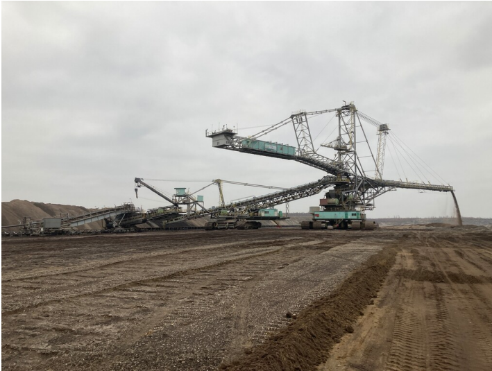
Bandabsetzer A2Rs-B 10.000.110 mit Gerätenummer 1124 Fotograf/Urheber: Nils Schinker
