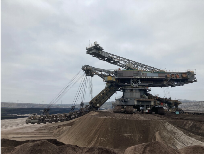
Eimerkettenbagger 1701 ERs 1120 Fotograf/Urheber: Nils Schinker
