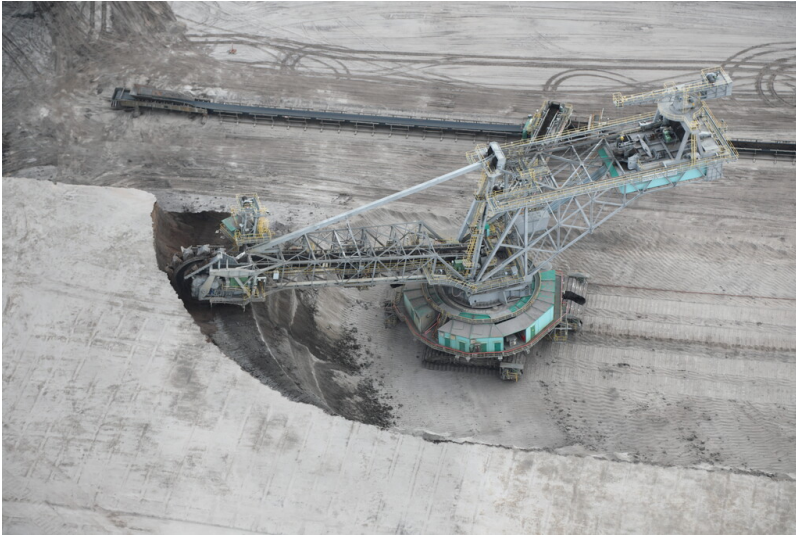
Schaufelradbagger 1528 SRs 2000, Luftbild Fotograf/Urheber: Ronald Heynowski
