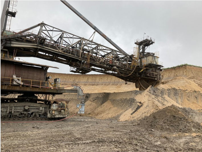
Schaufelradbagger 1552 SRs 2000, Detail Schaufelrad Fotograf/Urheber: Cynthia Thomas
