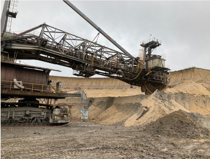
Schaufelradbagger 1552 SRs 2000, Detail Schaufelrad Fotograf/Urheber: Cynthia Thomas
