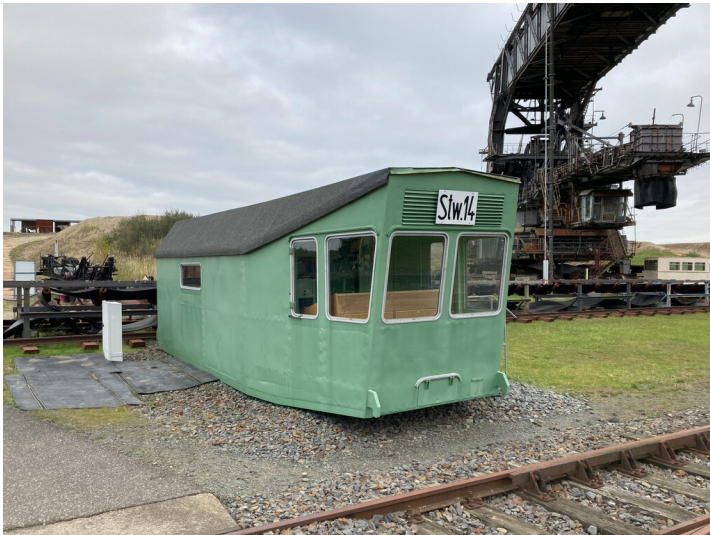
Teil der Objektgruppe Bergbau-Technik-Park (30600134), Stellwerk 14, mobiler Weichenposten im Typ Altenburg Fotograf/Urheber: Nils Schinker
