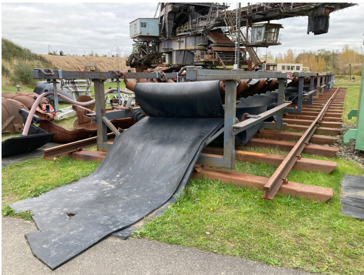
Teil der Objektgruppe Bergbau-Technik-Park (30600134), rückbare Bandanlagen Fotograf/Urheber: Cynthia Thomas
