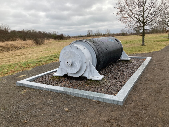
Umlenktrommel des Absetzers A2Rs-B 15000.100 aus nördlicher Richtung Fotograf/Urheber: Isabell Schmock-Wieczorek
