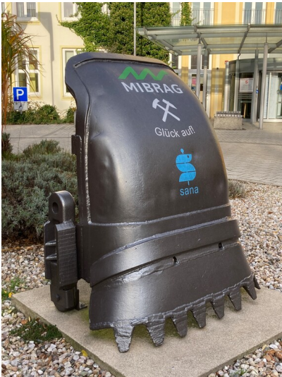
Bergbaugerät, Anlagenteil, Eimer eines Eimerkettenbaggers Fotograf/Urheber: Josephine Dressler
