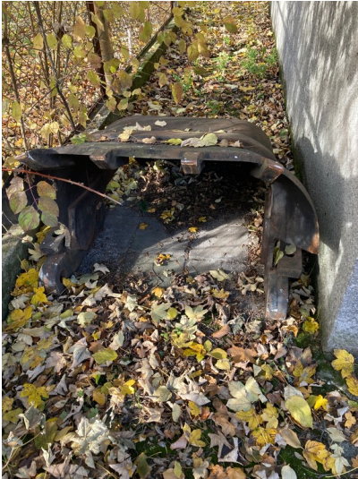
Eimer eines Eimerkettenbaggers aus der Sammlung des Stadtmuseums Borna Fotograf/Urheber: Isabell Schmock-Wieczorek
