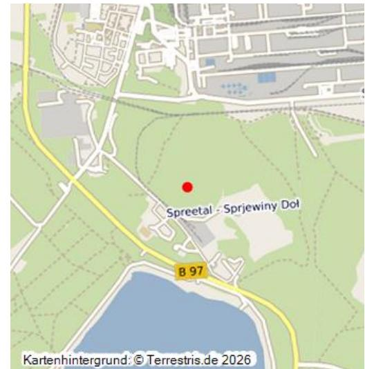
Am nordwestlichen Ufer des Tagebaurestsees Spreetal See befindet sich ein Einlaufbauwerk welches das Zuführen von Wasser in den See über einen Kaskadeneinlauf und eine Druckleitung ermöglicht. Der Zulauf des Wassers erfolgt über eine Heberleitung von der Grubenwasserreinigungsanlage des Kraftwerks Schwarze Pumpe. Der Kaskadeneinlauf befindet sich direkt am Ufer während das Ende der Druckleitung unter Wasser etwa 50 m vom Ufer entfernt liegt.
