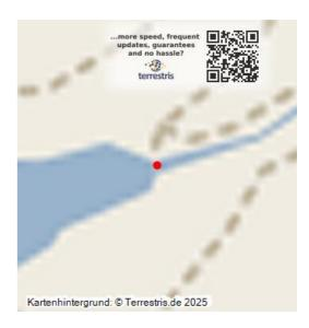
Im nördlichen Bereich des Ostufers des Tagebaurestsees Werbeliner See befindet sich ein Auslaufbauwerk. Dieses ermöglicht das Ableiten von Wasser aus dem Werbeliner See über den etwa 1500 m langen Überlaufkanal Brodauer Ableiter in den Bach Lober. Das Bauwerk ist Teil des Wassermanagementsystems, welches aufgrund des Braunkohlenabbaus in der Region nötig ist.
