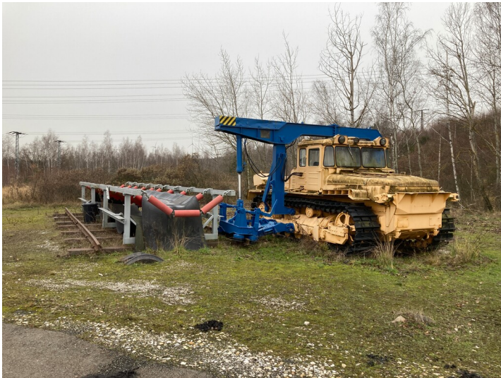
Tagebau Vereinigtes Schleenhain, sogenannte Russenraupe DET-250 mit Teilstück einer Bandanlage Fotograf/Urheber: Nils Schinker
