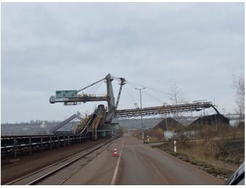
Tagebau Vereinigtes Schleenhain, Bandschleifenwagen mit Abwurftrommel und Schienenfahrwerk Fotograf/Urheber: Nils Schinker
