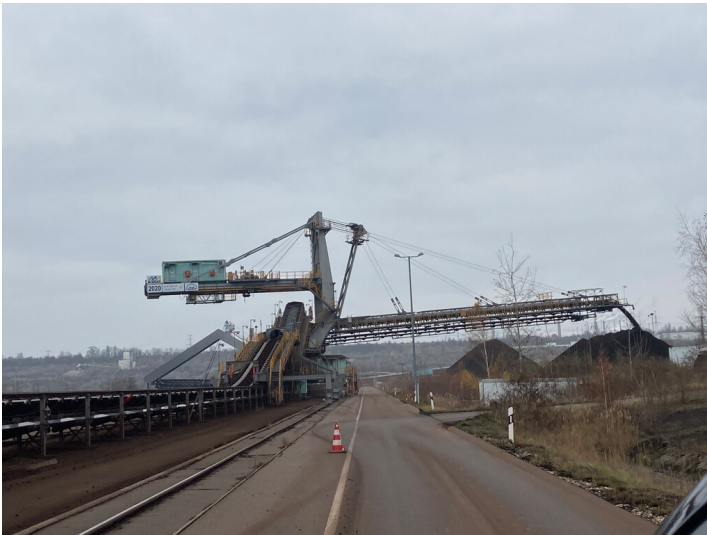
Tagebau Vereinigtes Schleenhain, Bandschleifenwagen mit Abwurftrammel und Schienenfahrwerk Fotograf/Urheber: Nils Schinker
