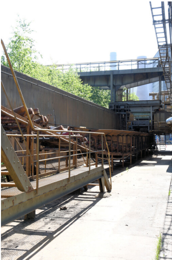
Kraftwerk Weisweiler: Ascheabsatzbecken, Aufgabetrichter des Aschebaggers und ehemalige Aschebandförderanlage, Ansicht von Westen; Foto: 13.03.2023 Fotograf/Urheber: Dr. Norbert Gilson
