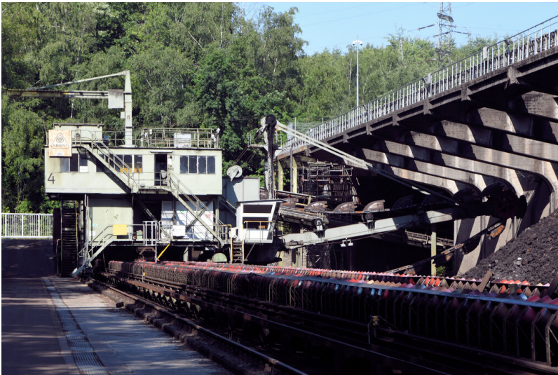
Kraftwerk Weisweiler: Bunkerbagger 4 in Grabenbunker 2, Baggergehäuse und Tragarm mit durchhängender Eimerkette, Ansicht von Osten; Foto: 13.06.2023 Fotograf/Urheber: Dr. Norbert Gilson
