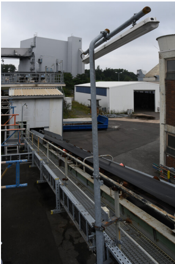
Kraftwerk Niederaußem: Rückhaltebecken, Teile der mechanischen Aufbereitung mit Förderanlage für Rückstände, Ansicht von Süden; Foto: 17.08.2023 Fotograf/Urheber: Dr. Norbert Gilson
