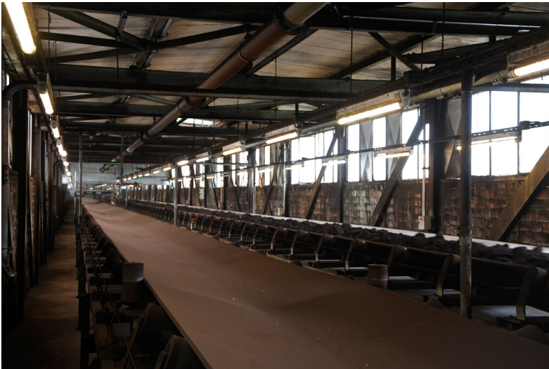
Kraftwerk Goldenberg-Werk: Bekohlungsweg von Bekohlungseckturm C zum Übergabeturm, Bandbrücke mit zweisträngiger Bandanlage in Richtung Südwesten zum Übergabeturm verlaufend; Foto: 23.05.2023 Fotograf/Urheber: Dr. Norbert Gilson
