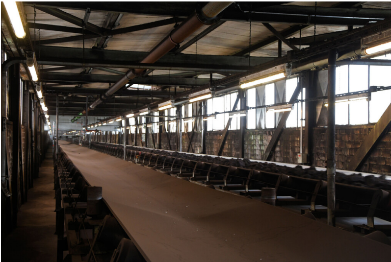
Kraftwerk Goldenberg-Werk: Bekohlungsweg von Bekohlungssekturm C zum Übergabeturm, Bandbrücke mit zweisträngiger Bandanlage in Richtung Südwesten zum Übergabeturm verlaufend; Foto: 23.05.2023 Fotograf/Urheber: Dr. Norbert Gilson
