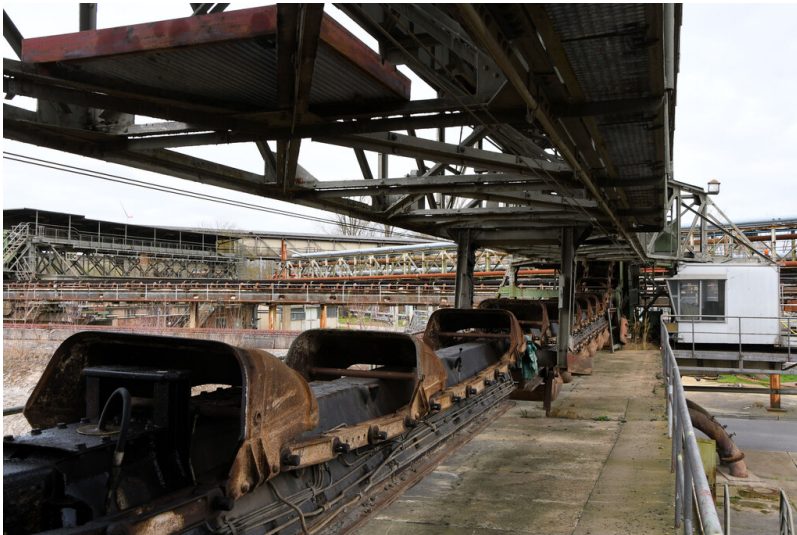
Kraftwerk Frimmersdorf II: Aschebagger 1 für Ascheabsetzbecken 1 (Taschen I bis III), obere Führung der Eimerkette und Führerstand, Ansicht von Südosten; Foto: 22.03.2023 Fotograf/Urheber: Dr. Norbert Gilson
