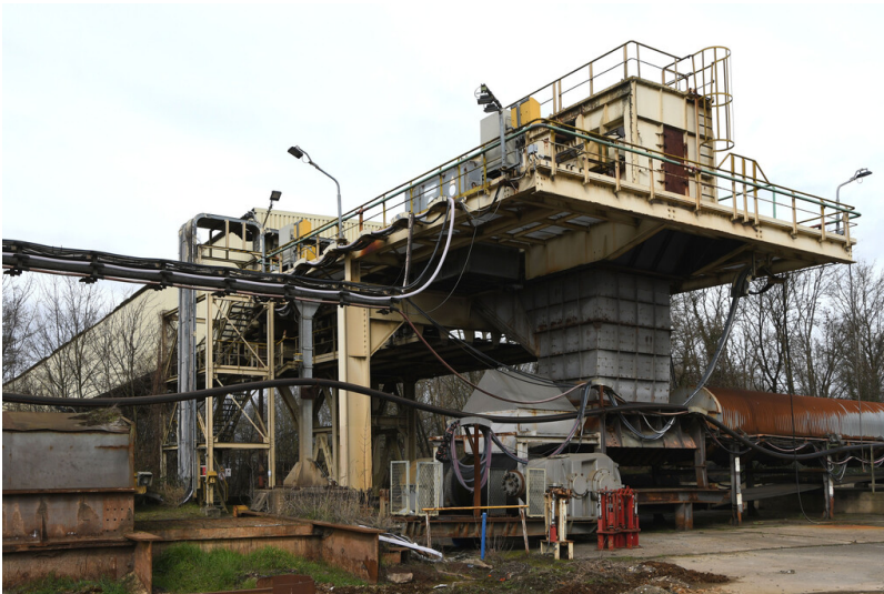
Kraftwerk Frimmersdorf II: Bekohlungsanlage, Übergabestation von der Bandanlage GF vom Kohlebunker Garzweiler auf das Bunkerbeschickungsband von Grabenbunker 2, Ansicht von Süden; Foto: 22.03.2023 Fotograf/Urheber: Dr. Norbert Gilson
