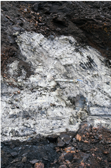
Tagebau Hambach, 6. Gewinnungssohle: ehemalige Entwässerungsstrecke, ""Schnüffelrohr"" (zur Bewetterung) und Wassersammler am Ende der mit Lehm verschlossenen untertägigen Strecke; Foto: 31.01.2023 Fotograf/Urheber: Dr. Norbert Gilson
